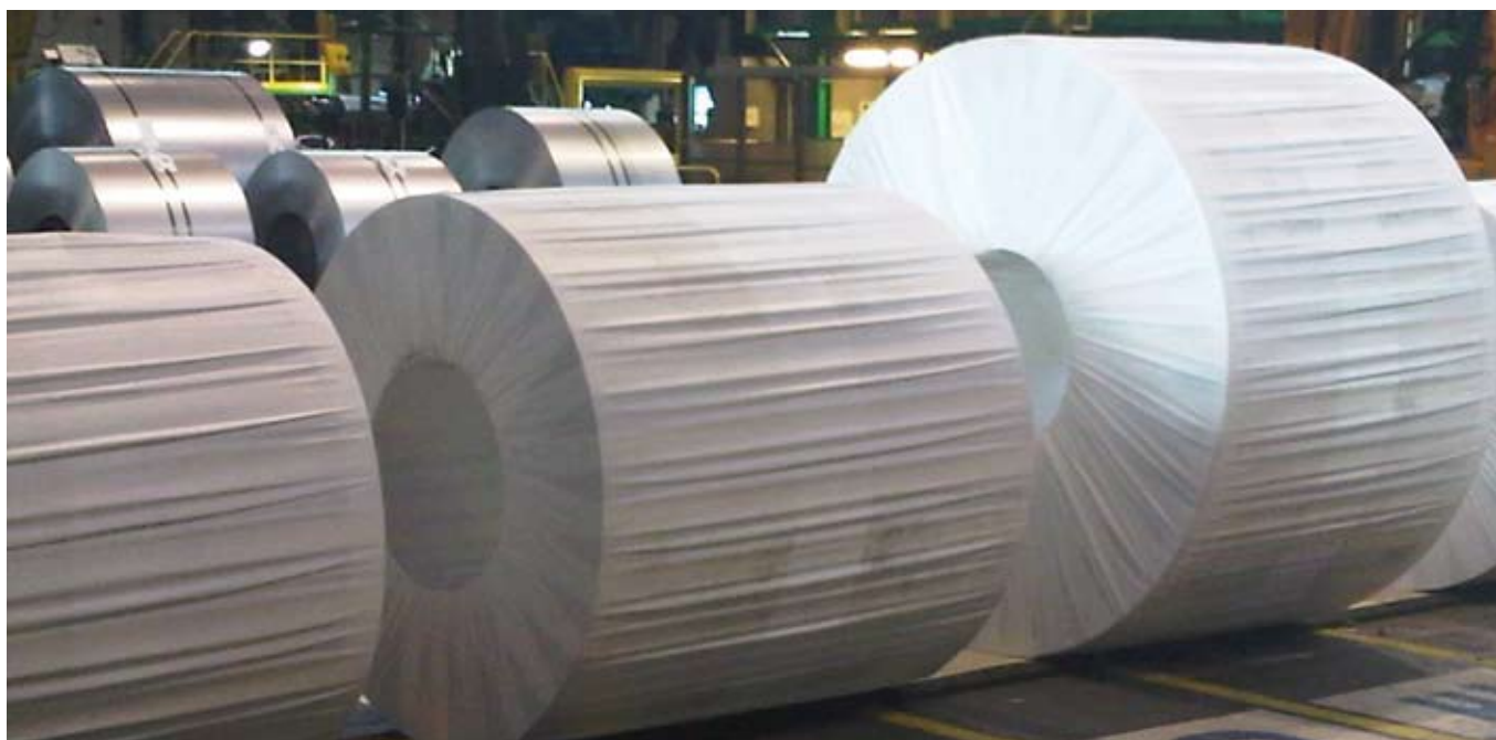
Ein Folien-Kokon für Stahl- und Aluminium-Coils. (Fotos: Flöter)
